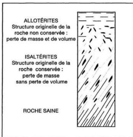
Fig. 2 - Profil d'altération type
