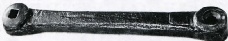
*Cloutière manuelle s'utilisant sur l'enclume classique du forgeron, la pointe du clou engagée dans le trou d'étampe. À noter que l'un des trous est carré et l'autre rond, destiné aux clous munis d'un collet rond entre la jambe pyramidale et la tête.*
