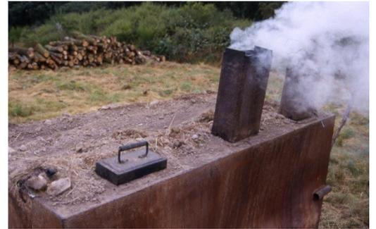
L'épaisseur des différentes pièces n'a pas été mesurée (entre 2 mm et 4 mm ?). Cette caractéristique, outre qu'elle implique un poids nettement différent, un coût également variable, doit avoir une influence sur la solidité de l'ensemble...et sans doute aussi sur la rapidité de la carbonisation et de son refroidissement...)
