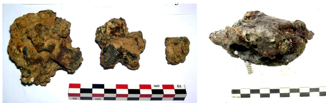
Figure 30 : Scories argilo-sableuses de forge
