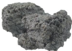
Figure 3 : Masses brutes de métal produites en bas fourneau. A gauche, une reconstitution ; à droite : un exemple archéologique (masse de l'Age du Fer trouvée dans une cave à Bourges)
