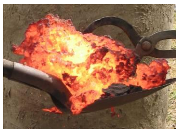
Figure 3 : Masses brutes de métal produites en bas fourneau. A gauche, une reconstitution ; à droite : un exemple archéologique (masse de l'Age du Fer trouvée dans une cave à Bourges)
