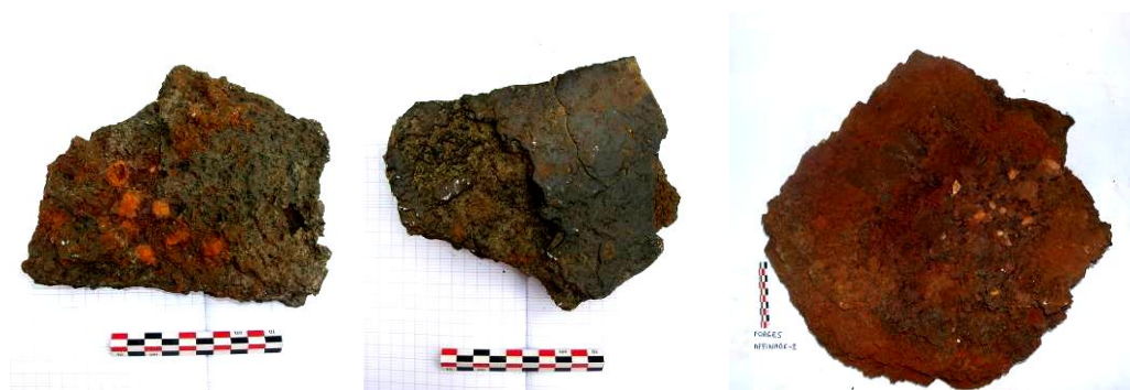
Figure 28 : Scories d'affinage de gueuse de fonte
