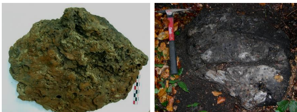
Figure 25 : Laitiers de haut fourneau produits aux environs du XVI e -XVII e siècle
