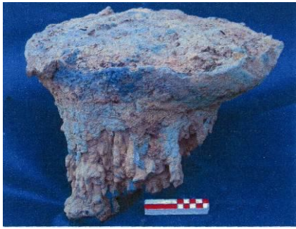
Figure 6 : Scorie piégée provenant du site de bois Jacob (tiré de Vivet 2007)
