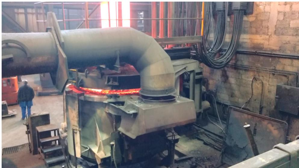
Figure 46. le couvercle se referme au dessus du four, assemblant le conduit d'évacuation des fumées.
