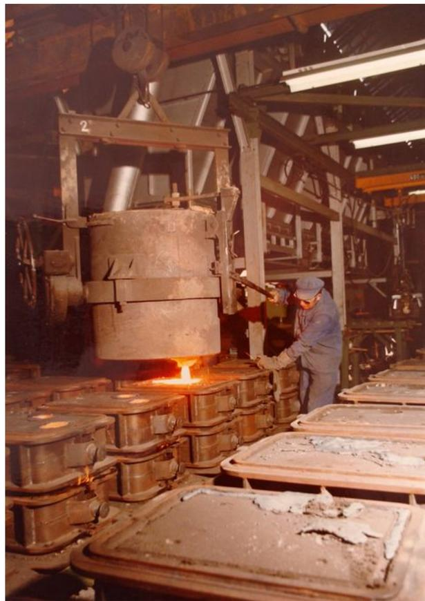
Figure 50. Coulée de l'acier avec une poche à quenouille.
