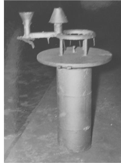
Figure 51. Atelier de démasselottage vers 1960 (g.). Pièce de tamponnement après grenailage et avant la casse (dr.)
