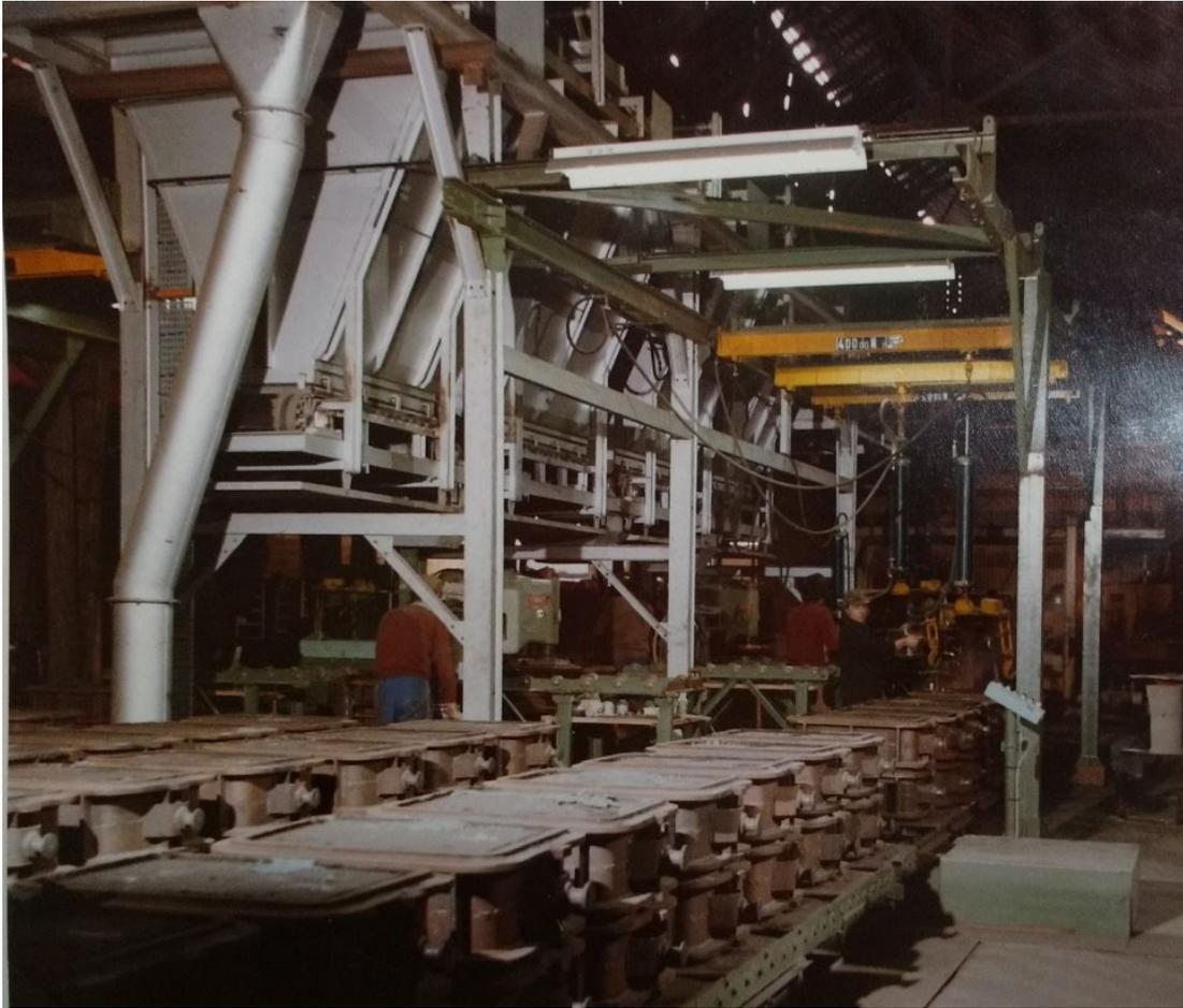
Figure 48. Poste de moulage, chantier de moulage semi-automatique.
