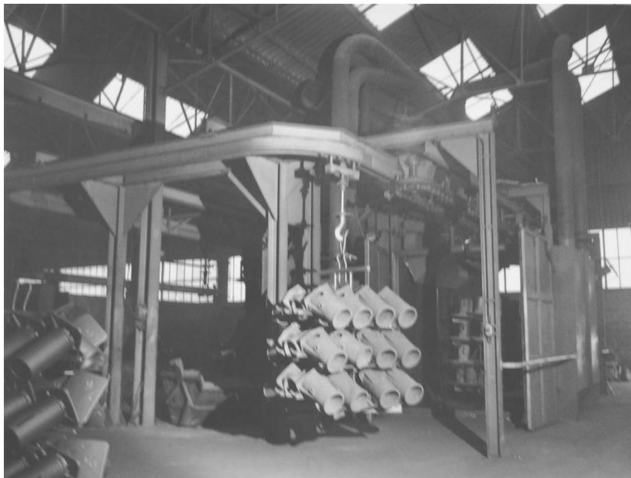
Figure 52. Poste de dessablage. Grenailleuse BMD. Source : Aciéries de Ploërmel (non daté)
