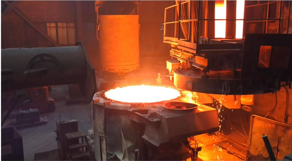
Figure 45. La benne de ferraille est amenée au dessus du four. Photographie prise le 15 mars 2018.
