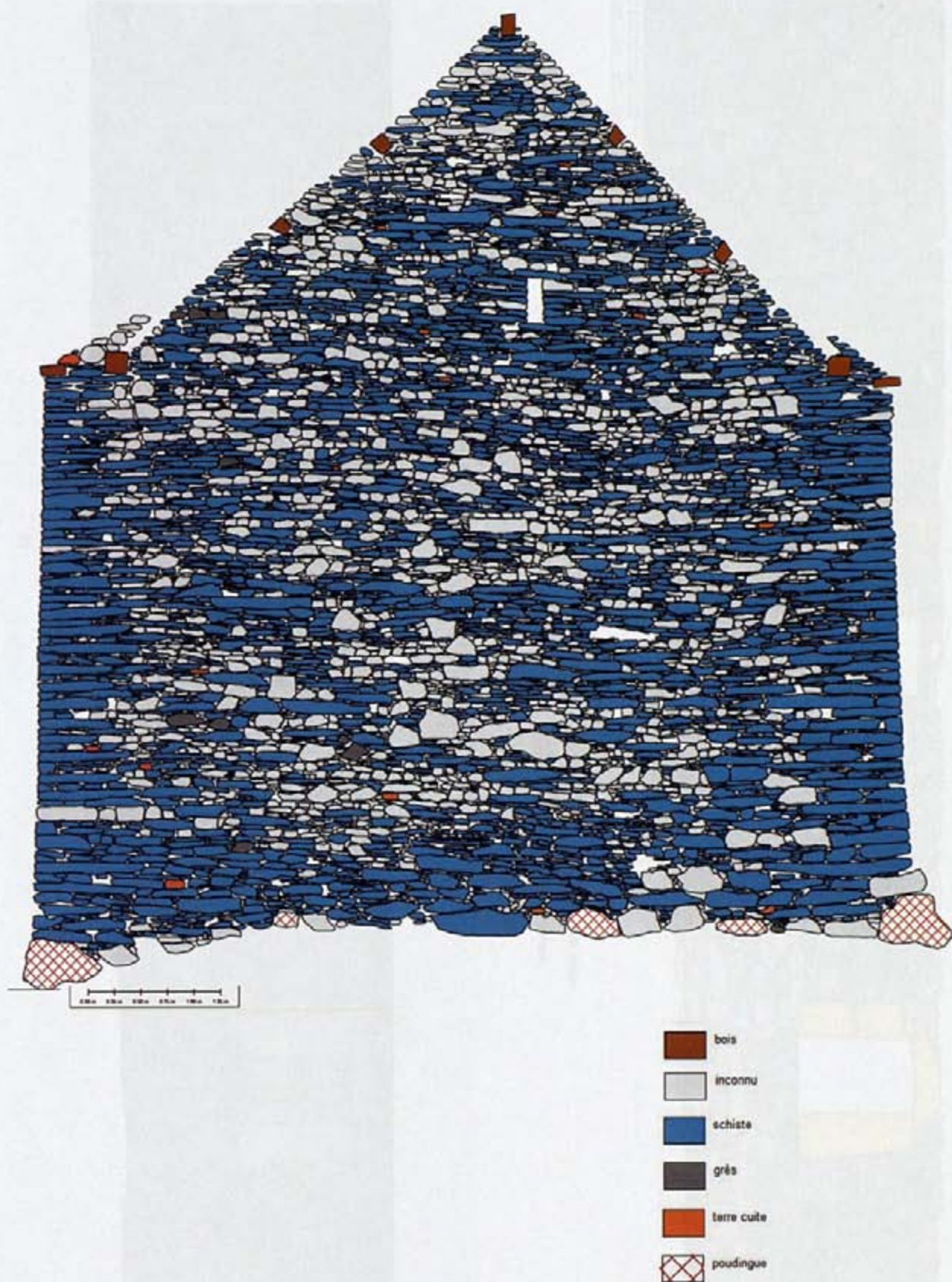
Fig. 34.b : répartition des matériaux du pignon ouest.
