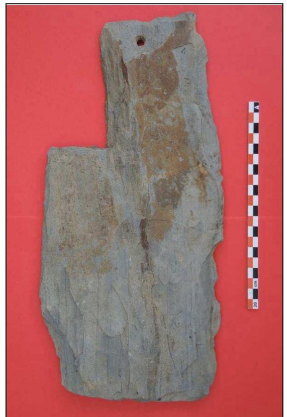
Photo 98 : ardoise taillée pour un passage de poutre
