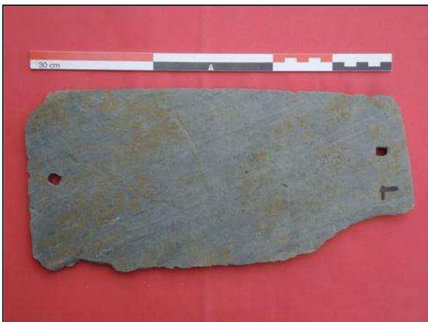
Photo 90 : trous aux deux extrémités de l'ardoise
