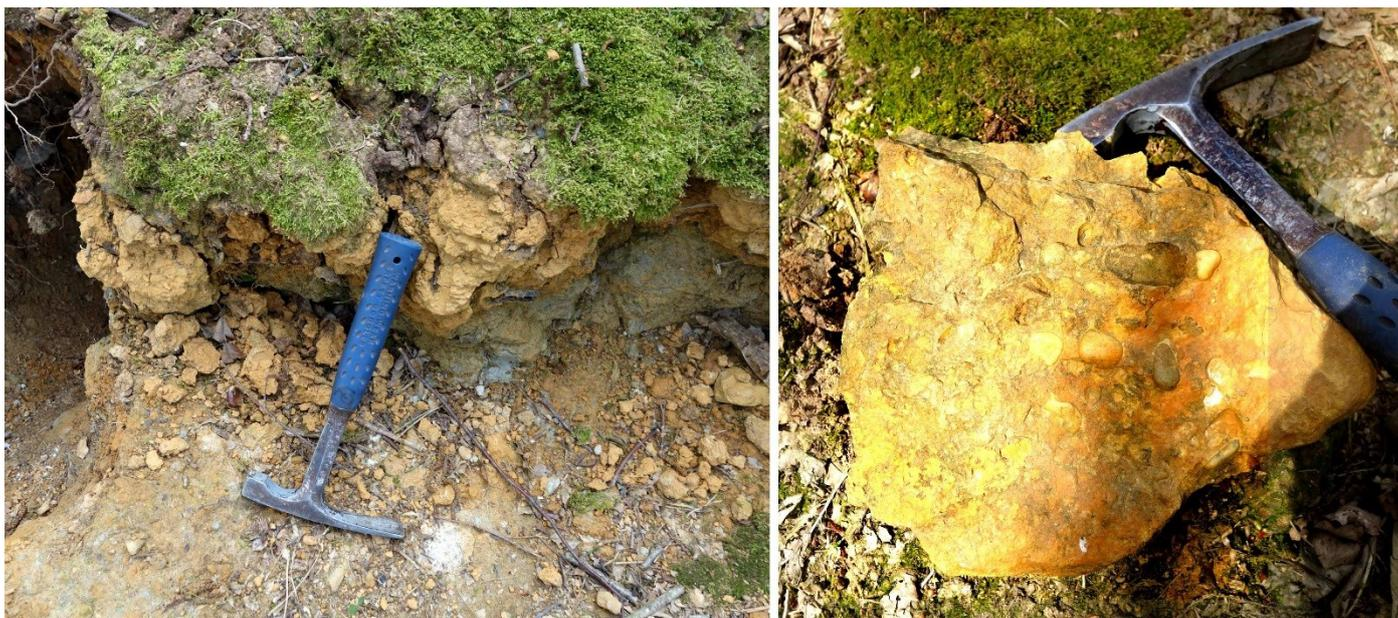
**Illustration 21 :** Site de **Castenouet** - **A gauche** débit en colonnes typique des sols argileux - **A droite** Conglomérat de galets arrondis, cimentés par du fer.
