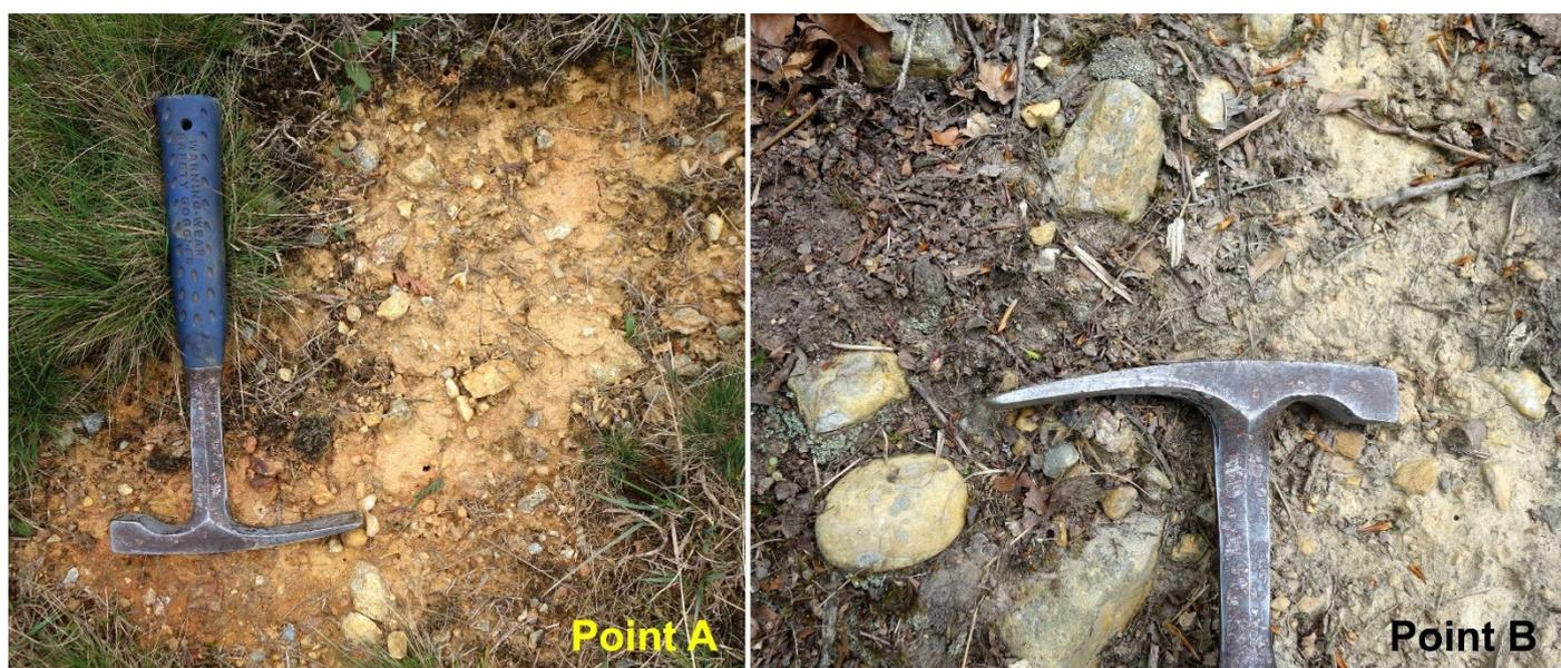
**Illustration 31:** Nord-Ouest Merdrignac : *Les petites Forges* –Faciès de la nappe (RF) : petits galets de quartz enrobés dans une matrice limono-sableuse dénuée de ciment ferrugineux.
