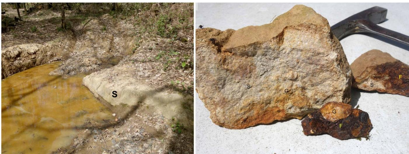
**Illustration 15 :** Site du **Verger** - anciennes carrière – dalle silicifiée (**S**) - **A droite** : Les fragments et galets (**G**) peuvent être enrobés soit dans une matrice siliceuse (**S** dominante) soit dans une matrice ferrugineuse (**F**).
