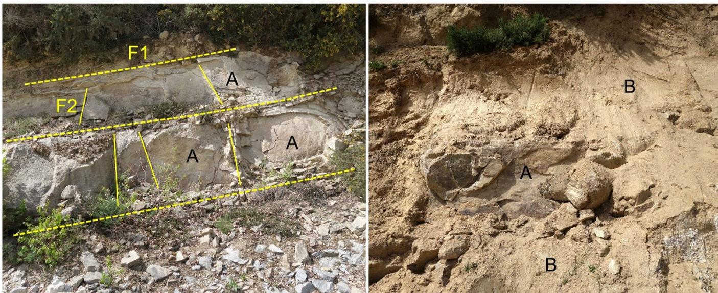
**Illustration 8 :** Granite de Ménéac (Carrière LESSARD) – Débitage des « boules granitiques » F1 et F2 : familles perpendiculaires de diaclases – A : naissance des boules (débits en pelures d'oignon le long des diaclases) – B : Arénisation du granite isolant les boules résiduelles de roche saine.
