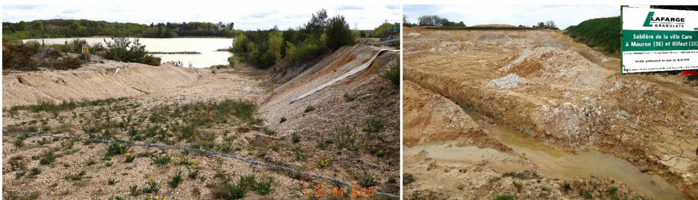
La carrière exploitée par **Lafarge Granulat** nécessite une autorisation pour visiter la partie actuellement exploitée. Les bacs de décantation des boues argileuses issues du lavage in situ des sables extraits (photo ci-dessus) permettent de combler les sites antérieurs vidés de leur sable. Ces boues n'étant pas stables il est impératif de les éviter sous peine d'enlèvement.
