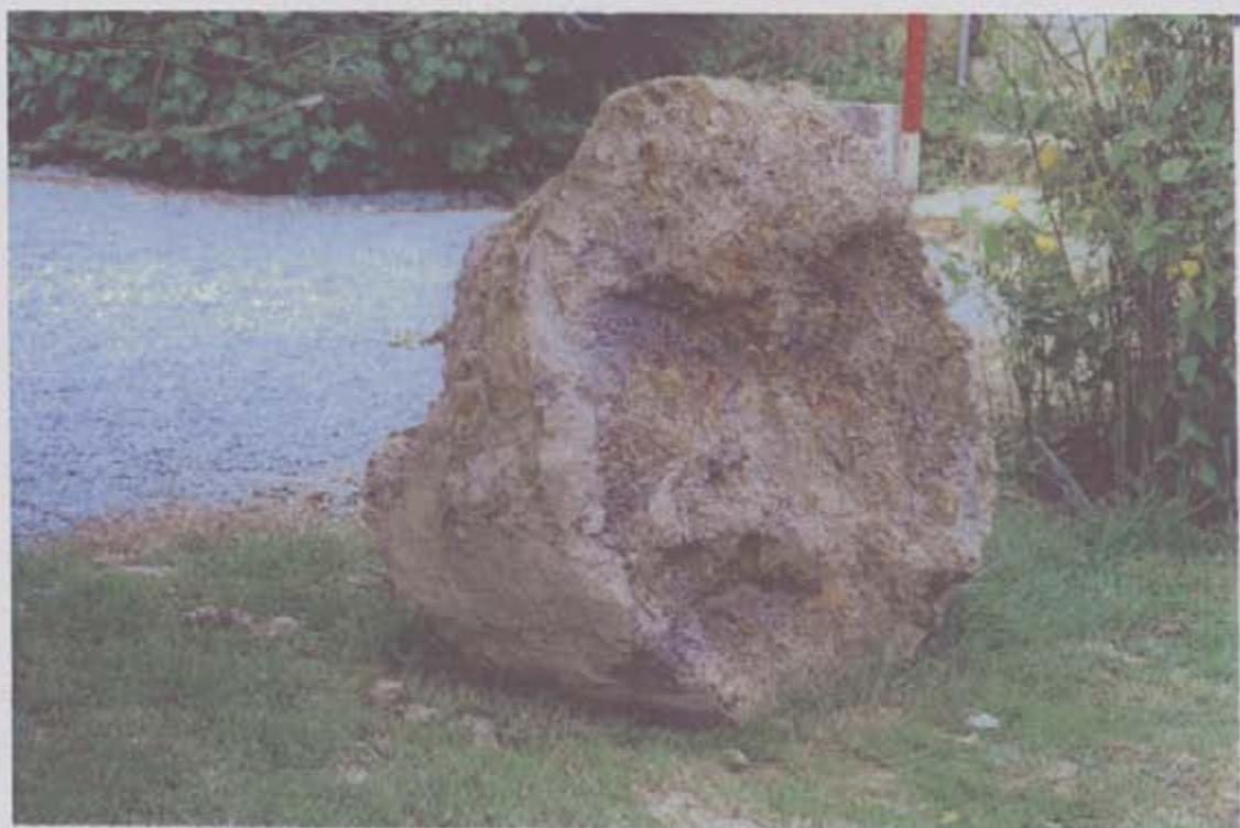
Photo n° 9 et 10 : Le Bas Chesnais II en TADEN (22) scorie de fond de four piégée – datation C14 – vue de profil (jalon de 1 m) et vue du dessous.
