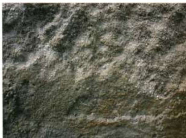
Vue de détail du grès briovérien de structure homogène (pas de litage)
