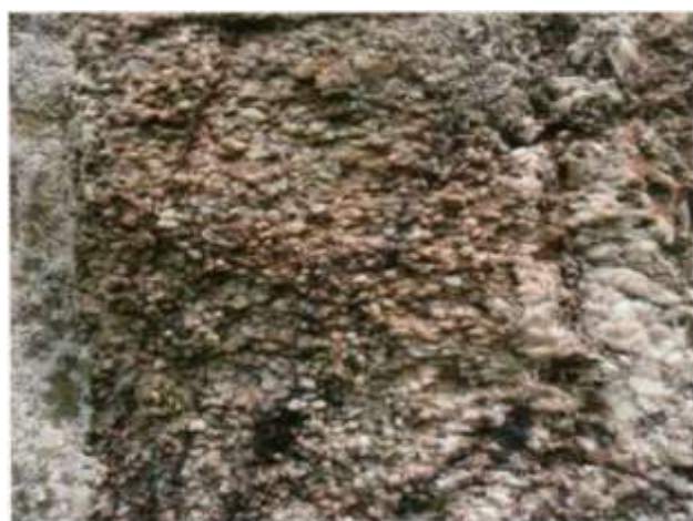
Détail d'un autre bloc de Gourin, caractérisé par l'abondance des galets de quartz blanc. La matrice est ici légèrement colorée par des hydroxydes ferriques.
